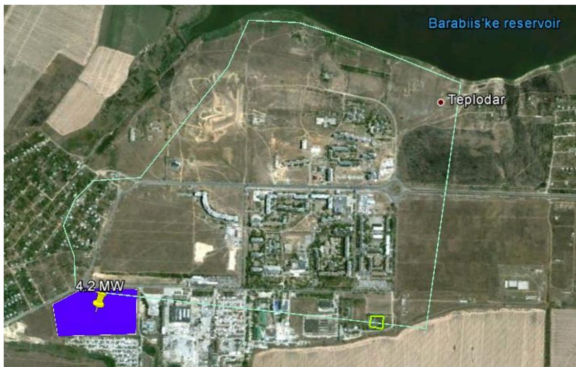
Проект предусматривает установку 17 182 солнечных фотогальванических модулей мощностью 245 пиковых Вт, а также 12 инверторов с номинальной мощностью каждого 330 пиковых кВт. Запланированная установленная мощность проекта составит 4,209 мегаватт, что обеспечит среднегодовое производство электроэнергии 4,916 миллионов киловатт-часов.
